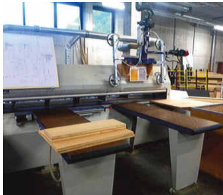
/ Der Vakuumheber ist platzneutral am richtigen Standort untergebracht. So wird Fläche eingespart.
