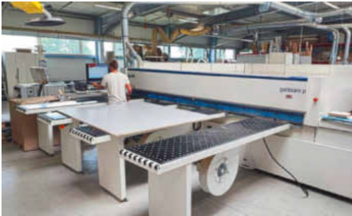
/ Herzstücke der Schreinerei sind die horizontale Plattenaufteilsäge Gabbiani P und die 5-Achs-CNC Morbidelli Author M 100 von SCM.
