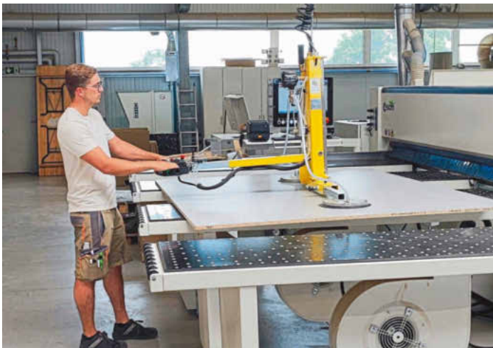
/ Ergonomisches Arbeiten hat hohe Priorität: Mit einem Vakuumheber von Hova können die Platten problemlos von einer Person gehandelt werden.
