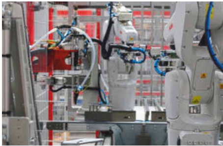
/ Der Beschlagsautomat setzt die Eck- und Scherenlager präzise auf die Rahmen und schraubt sie fest.
