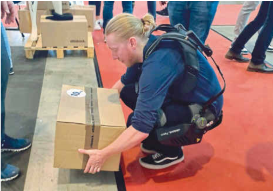
/ Beim Ottobock Back wird die Last an der Schulter abgenommen und in die Oberschenkel umgeleitet. Der Energiespeicher nimmt beim Beugen Kraft auf und gibt sie beim Heben wieder ab.
