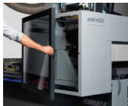
Für einen schnellen Zugang bei Bohrerwechseln, Reinigungs- oder Wartungsarbeiten kann die Haube einfach geöffnet werden.
