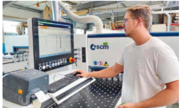
/ Damit die einzelnen Bauteile jederzeit dem Auftrag zuordenbar sind, erhalten die zugeschnittenen Elemente ein Etikett zum Aufkleben.
