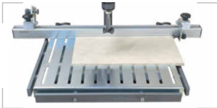
/ Die Ruwi-Aufspannplatte mit Nuten zur Fixierung von Werkstücken auf Maschinentischen erhält mehrere Upgrades für eine effizientere Nutzung.
