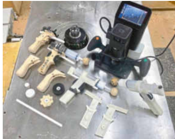
Die ersten Prototypen fertigte Christian Hedwitschak mit der Origin von Shaper Tools, für die letzten nutzte er einen 3D-Drucker.
