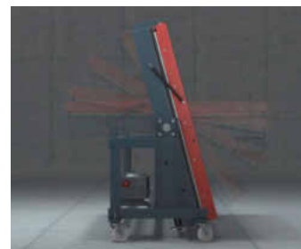
/ Der Klappmechanismus reduziert die Grundfläche der Vakuumpresse auf 45 %.
