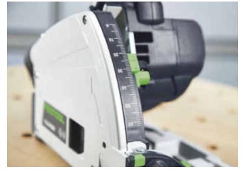
/ Exakte Tiefeneinstellung: Doppelzeiger und Feineinstellung garantieren das genaue Einstellen.
