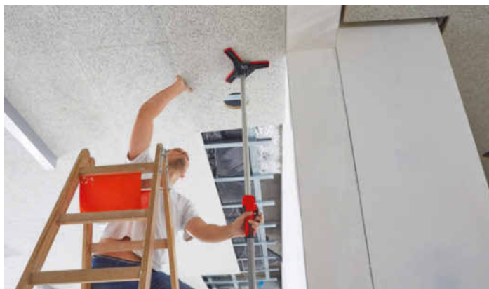
/ Das 350 g leichte Deckenstativ STE-DS ist passend für Deckenstützen mit einem Außendurchmesser des teleskopierbaren Innenrohrs von 25 und 28 mm.
