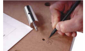
/ Auch die Bohrungen für die Schraubbankhaken werden ausgefräst.
