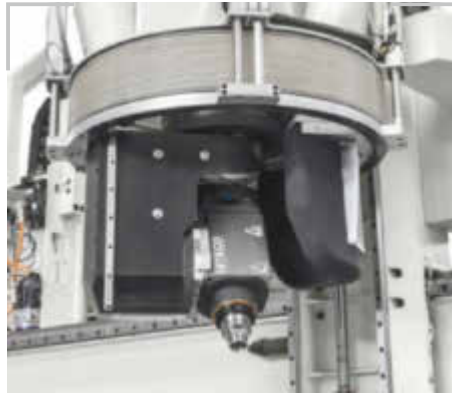
/ Die Aggregate mit Elektroschneidspindeln können für eine vier- oder fünfschneidige Bearbeitung ausgestattet werden.
