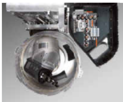
Die Hauptspindel: 5 Achsen – keine Einschränkungen
