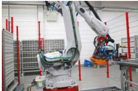
/ Der Abstapel-Roboter hinter dem Zuschnitt- und Bearbeitungszentrum sortiert die Profile in den Wagen.
