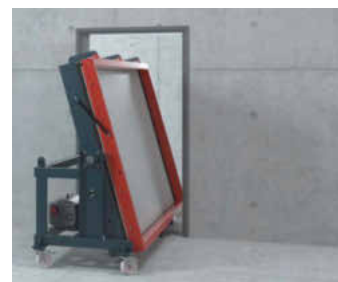
/ Mit reduzierter Grundfläche passt die Vakuumpresse durch jede Standardtür.
