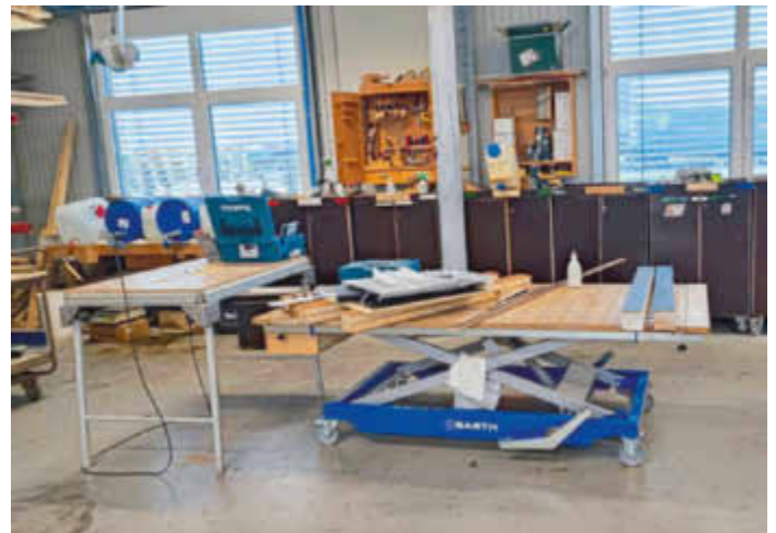
/ Im Bankraum setzt sich der ergonomische Ansatz fort. Dort finden sich flexible Arbeitsplätze: Hubtische von Barth und selbst gefertigte Werkzeugschränke auf Rollen.
