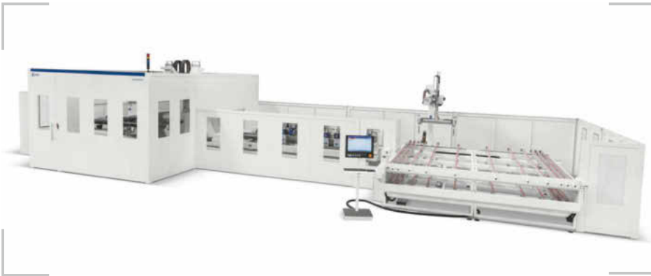
/ Die Modulbauweise des Arbeitstisches der Windorflex ermöglicht die Bearbeitung von drei Werkstücklängen 3500, 4500 und 6000 mm.
