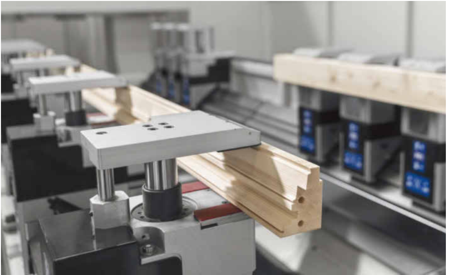
Der automatische Arbeitstisch der Windorflex verfügt über ein Spannsystem, auf dem die Werkstücke stets eingespannt sind. So wird sichergestellt, dass sämtliche Bearbeitungen trotz Umspannen exakt ausgeführt werden.
