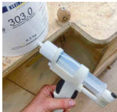
Mithilfe des Bedienrades lässt sich die Pistole schnell befüllen und die Leimauftragsmenge genau dosieren.
