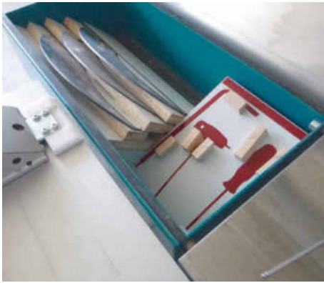
/ Schattenbretter können zum Beispiel mit Klebefolie aus dem Schneidplotter erstellt werden.
