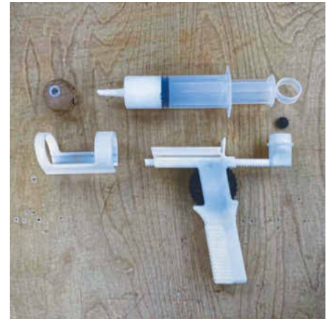
Cleverer gemacht: Durch das einfache System lassen sich mehrere Spritzen mit nur einer Pistole verwenden.
